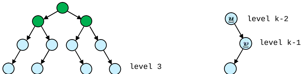
Şekil 5.29 k-2 seviyelerindeki düğümlerin 2 çocuğu vardır.
